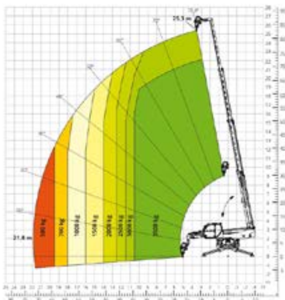
Lastdiagramm mit SEILWINDE 3.500 kg ATT-02-002
