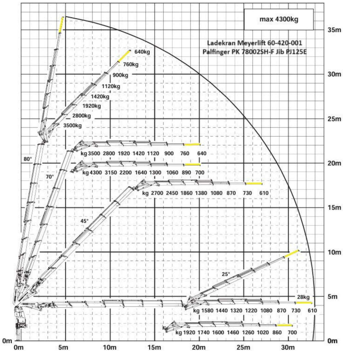
Hinweis: Der gelb Markierte Bereich ist ein manueller Ausschub, arbeiten in diesem Bereich nur nach Rücksprache. Seilwindenbetrieb hier nicht möglich.
