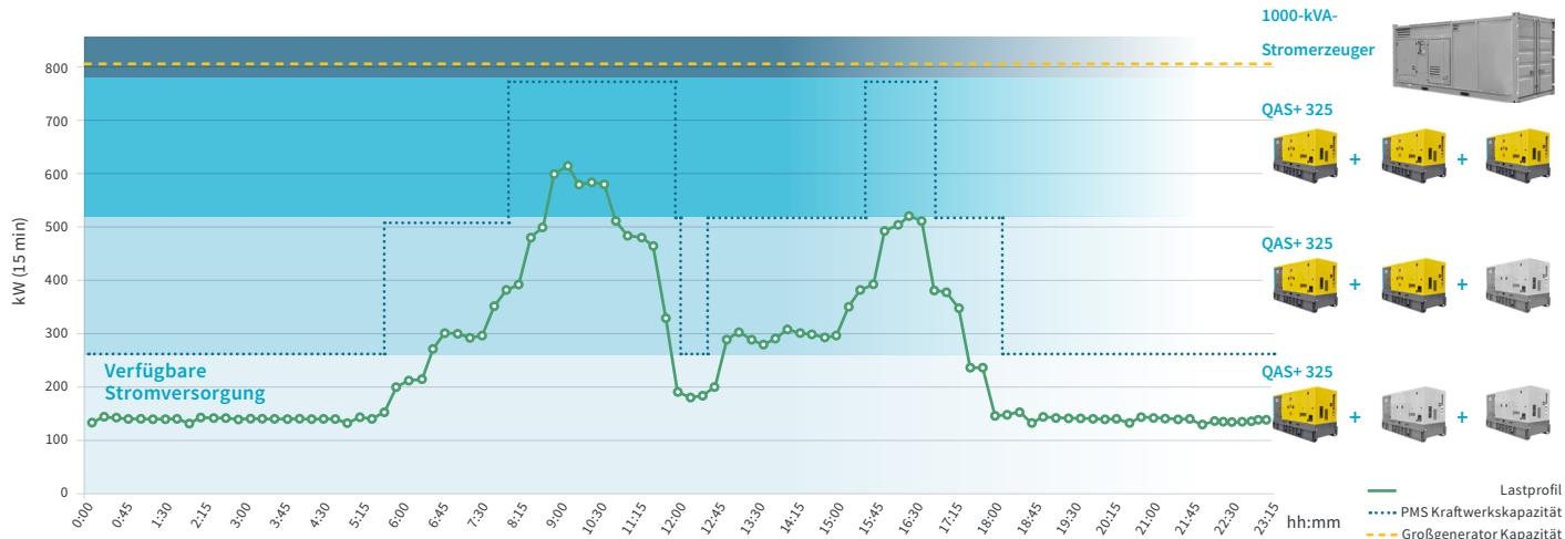
Hinweis: Dies sind Simulationsdaten. Sie basieren auf einem typischen Tageslastdiagramm im industriellen Bereich.
