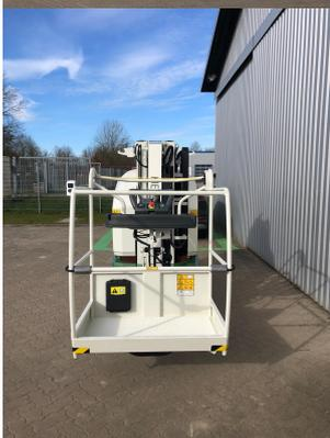
**Sonderausstattung:** Kompakte Abmessungen zum Erreichen schwer erreichbarer Stellen. Vielseitiger Gelenkausleger für eine horizontale Reichweite und Knickpunkthöhe. 345° drehbarer Hubmast für unerreichte Positionierungsmöglichkeiten. Umfahren zahlreicher Hindernisse am Boden und in der Luft. Der Toucan 12E Plus ist mit einer Korbdrehfunktion ausgestattet.
