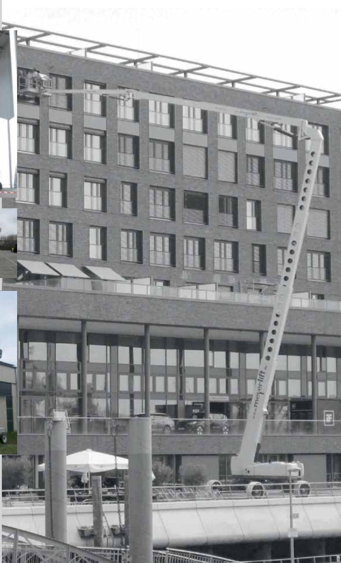
Zu mieten sind bei den **Gelenkteleskopbühnen** Elektro- und Dieselmotoren. Die selbstfahrenden Gelenkteleskopbühnen mit **Elektroantrieb** kommen überwiegend im **Innenbereich** zum Einsatz.
