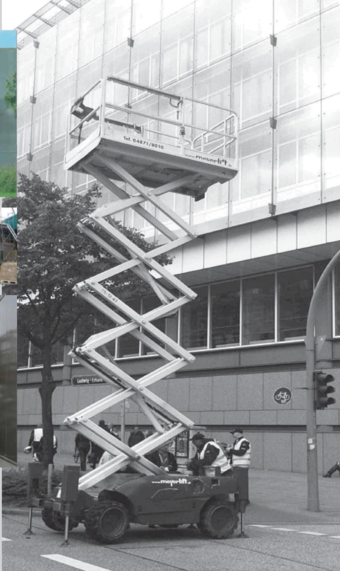
**Diesel Allrad Scherensarbeitsbühnen** eignen sich aufgrund ihrer Bauweise und ihrer Antriebstechnik hervorragend für **Einsätze im Gelände** bzw. im **Außenbereich**. Darüber hinaus lassen sich die Arbeitsbühnen selbstverständlich auch **hydraulisch abstützen**. Alle Scheren-Arbeitsbühnen können von der Arbeitsplattform aus gesteuert werden und sind **aus voller Höhe verfahrbar**.
