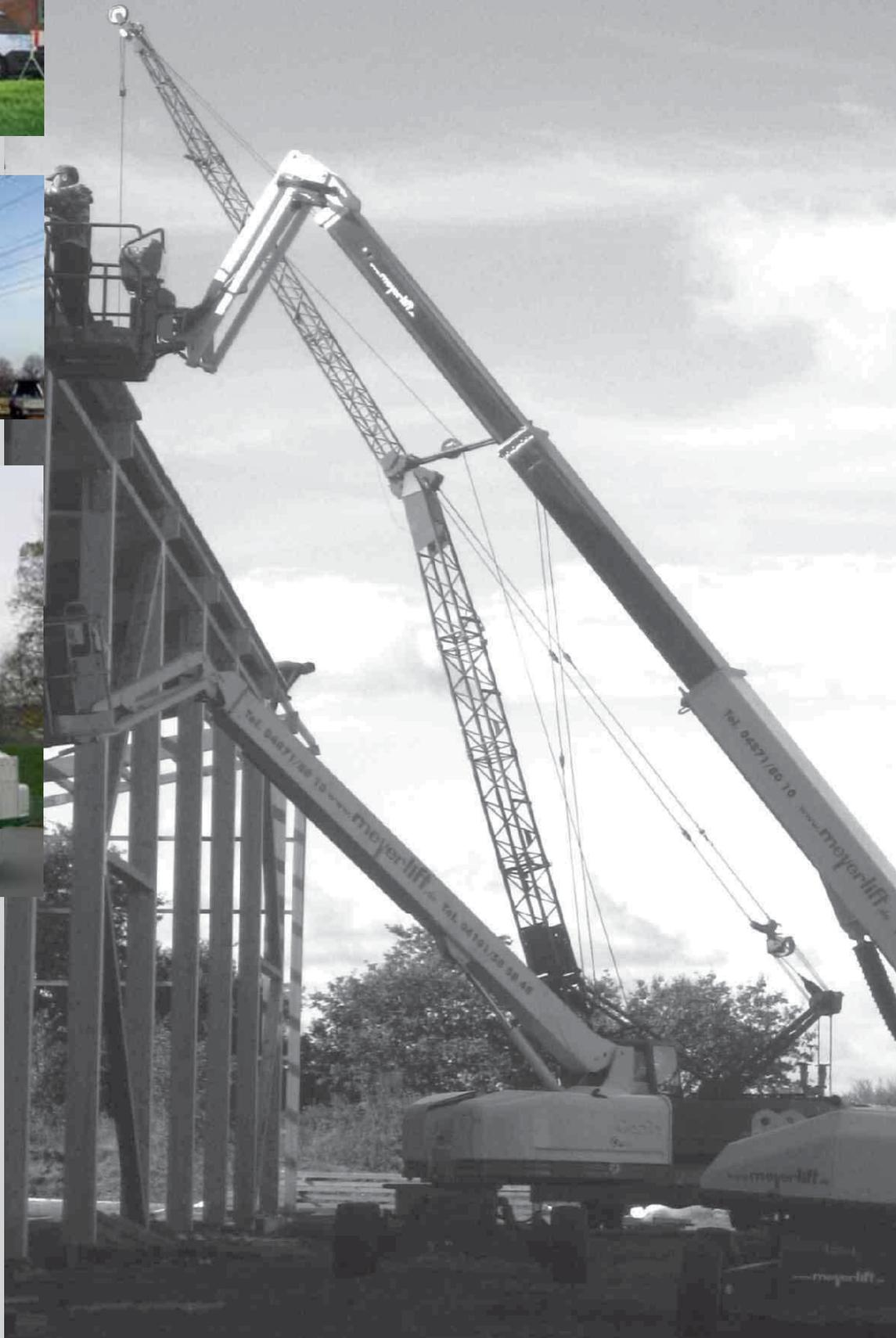
Speziell im **Gelände** kommen die **Allrad-Teleskoparbeitsbühnen** zum Einsatz. Die Geräte verfügen über ausgeschäumte Reifen mit einem groben Profil. Durch die Möglichkeit **schwierigste Untergründe** zu bewältigen und die Fähigkeit, in großen Hubhöhen und Reichweiten zu arbeiten, stellt für Teleskoparbeitsbühnen kaum eine Gegebenheit ein Hindernis dar.
