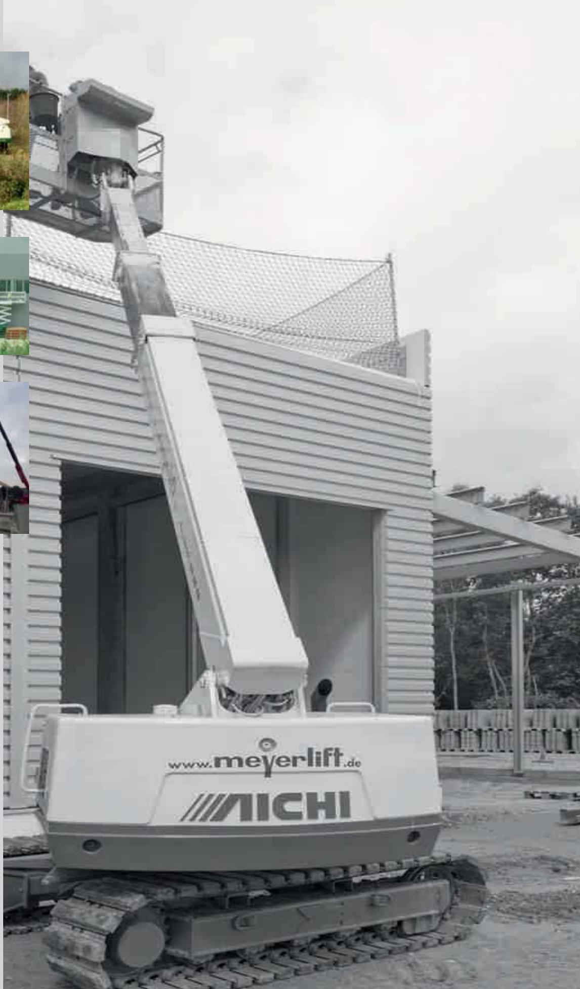
AICHI Kettenbühnen sind der ideale Wegbegleiter für schweres, unwegsames Gelände. Diese Arbeitsbühnen lassen sich weder von Sand, Schlamm, Morast oder Geröll stoppen. Die Teleskopbühnen auf Kettenfahrwerk (mit Gummipads) verfügen über eine Arbeitshöhe von 14,00 m bis 23,00 m, teilweise mit Korbarm und ermöglichen so die notwendige Flexibilität zum Arbeiten in der Höhe.
