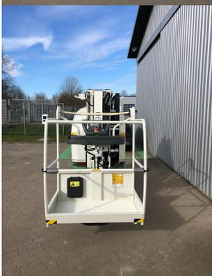
**Sonderausstattung:** Kompakte Abmessungen zum Erreichen schwer erreichbarer Stellen. Vielseitiger Gelenkausleger für eine horizontale Reichweite und Knickpunkthöhe. 345° drehbarer Hubmast für unerreichte Positionierungsmöglichkeiten. Umfahren zahlreicher Hindernisse am Boden und in der Luft. Der Toucan 12E Plus ist mit einer Korbdrehfunktion ausgestattet.
