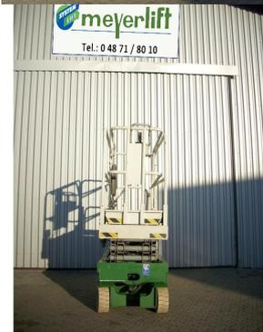
**Sonderausstattung:** Diese Scherenbühne verfügt über einen Elektroantrieb, daher emissionsfrei. Weiße, abriebfreie Vollgummireifen und einen Plattformausschub. Deshalb ist das Arbeiten mit dieser Bühne sehr gut für den Innenbereich geeignet.
