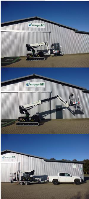
Arbeitspositionen mit einer nicht vollständig ausgefahrenen Kette: maximale Höhe und maximale Reichweite.
